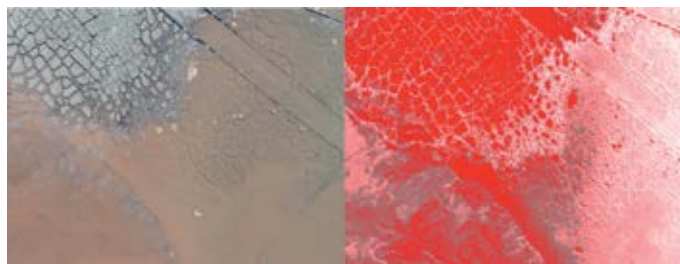
Figura 9: Contraste entre zona seca y saturada mediante la utilización de índice NDVI
