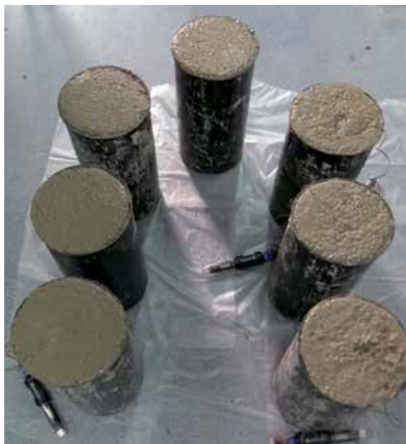
Figura 2: Probetas cilíndricas de dimensiones normales con cables termopares
