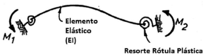
Figura 10: Elemento tipo Giberson para modelar no linealidad en estructura original sin uniones híbridas
