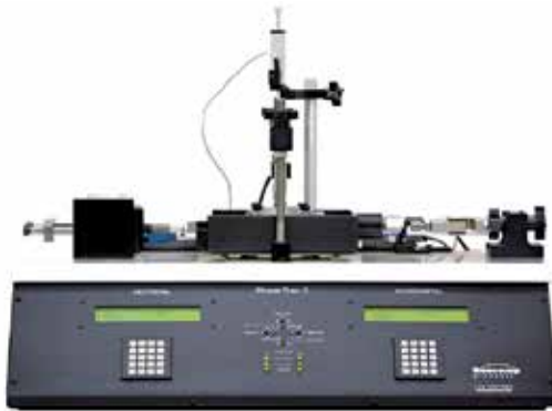
Figura 6: Equipo GEOTEST utilizado para ensayos de resistencia cíclica de relaves cementados
