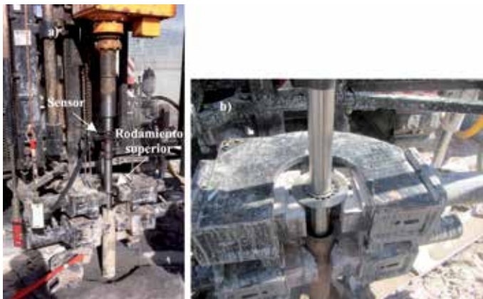
Figura 8: a) Rodamiento en sistema montado y b) acercamiento rodamiento superior
