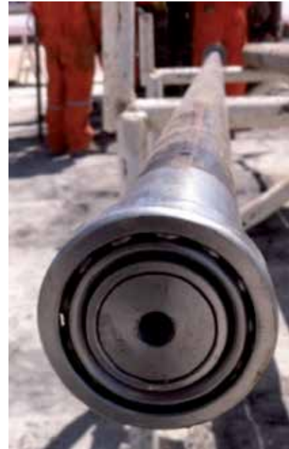
Figura 9: Rodamiento inferior, con sistema para conexión de veleta
