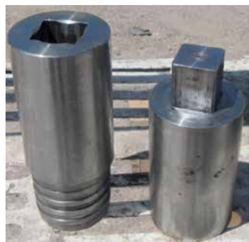
Figura 5: Acoples con dado para conexión macho-hembra a torquímetro
