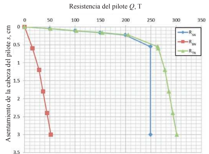
Figura 7: Curva resistencia versus asentamiento de acuerdo a FHWA 1999
