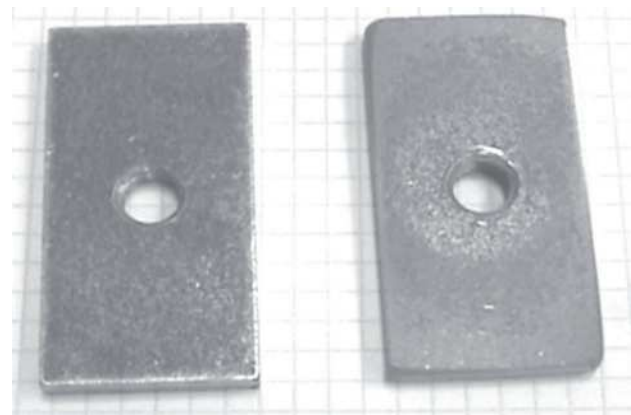
Figura 12: Paleta metálica antes y después del ensayo
