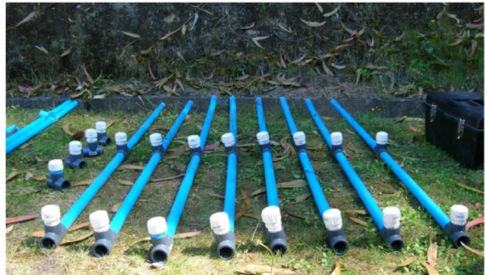
Foto 10: Configuración del sistema de lluvia
