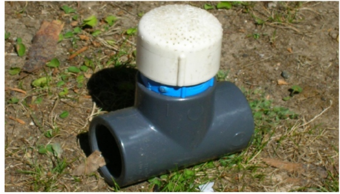
Foto 9: Aspersores fabricados de tapas perforadas conectadas a TEE
