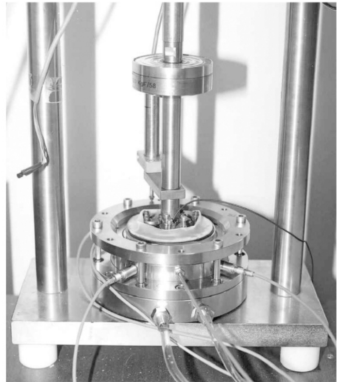
Figura 6: Edómetro osmótico disponible en los laboratorios de Imperial College.
