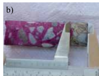
Figura 9: a) Definiciones de nivel de serviciabilidad (desempeño) de una estructura en el tiempo (ISO16311, 2014), b) mediciones END de ingreso de carbonatación y cloruros y c) nivel de corrosión de armaduras
