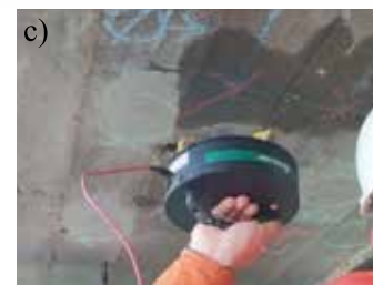
Figura 9: a) Definiciones de nivel de serviciabilidad (desempeño) de una estructura en el tiempo (ISO16311, 2014), b) mediciones END de ingreso de carbonatación y cloruros y c) nivel de corrosión de armaduras
